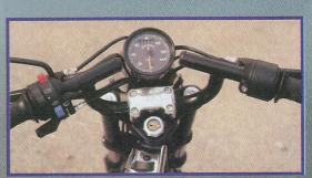
L'antivol intégré dans la colonne de direction et se place dans le bras oscillant, le petit guidon, le starter, l'éclairage et le coupe-circuit (rouge) à gauche. Au centre trône le très joli compteur obus qui s'éclaire lui aussi. On appréciera le stop qui s'allume avec les 2 freins.
