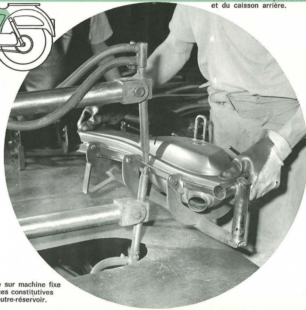
Pointage sur machine fixe des pièces constitutives de la poutre-réservoir.
