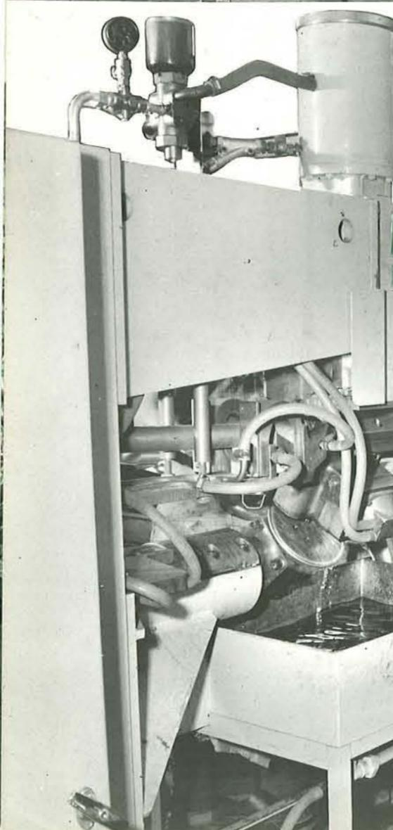
Fabrication en chaîne du sous-ensemble avant : la poutre-réservoir. Les éléments constitutifs, deux demi-coquilles et l'âme, sont préassemblés par quatre points de soudure, puis soudés à molettes en cordon continu étanche, les épaisseurs assemblées sont de 1,2 + 1 + 1,2 mm. Un tapis transporteur achemine les pièces aux différents postes de travail.
