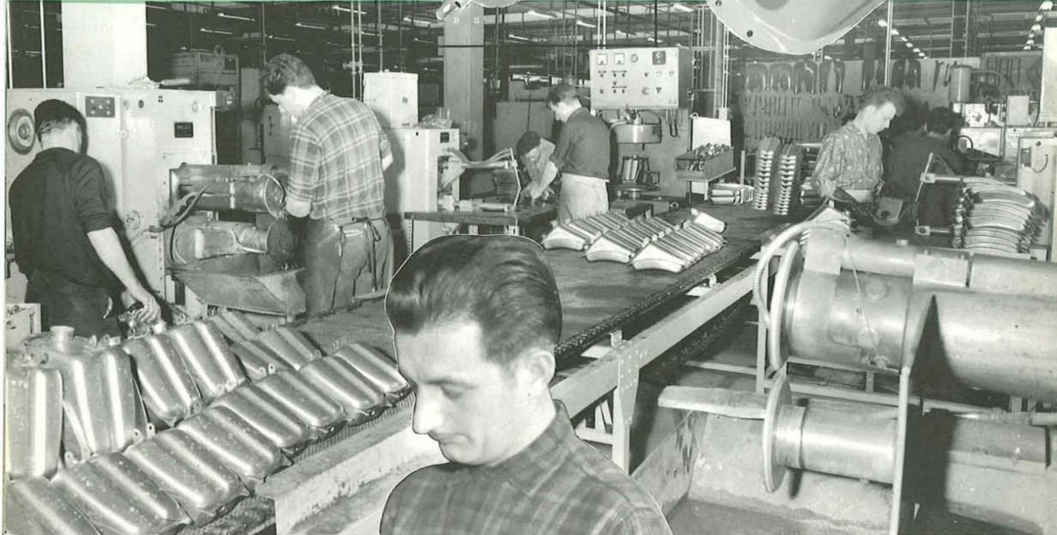
Soudage en chaîne du réservoir auxiliaire d'AV 42
